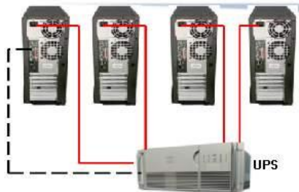
Gambar.3. Konfigurasi instalasi UPS secara bersama dengan satu server
