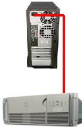
Gambar.1. Konfigurasi instalasi UPS secara stand alone
